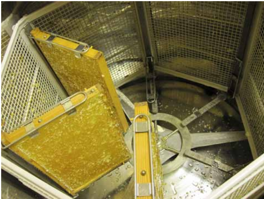
När ramarna är avtäckta slungas honungen ut ur vaxkakan i en centrifugliknande slunga.
